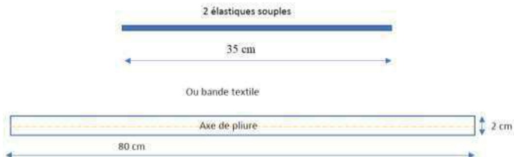
Figure 8 —à plis - Dimensionnement du jeu de brides
